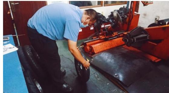
**Gambar 1.** Pengukuran Dimensi Ban Motorcycle Sebelum Rancang Bangun
