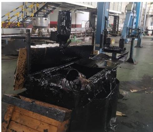
**Gambar 3.** Alat Pelapisan Bitumen Sebelum Rancang Bangun Alat
