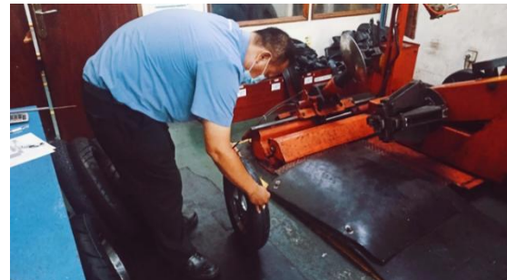
Gambar I. Pengukuran Dimensi Ban Motorcycle Sebelum Rancang Bangun (Sumber: Kajian Penulis, 2021)
