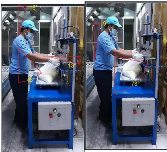
**Gambar 10** Postur Pekerja Pada Mesin Sealing Baru
