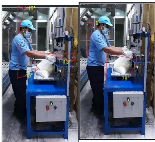
Gambar X Postur Pekerja Pada Mesin Sealing Baru
