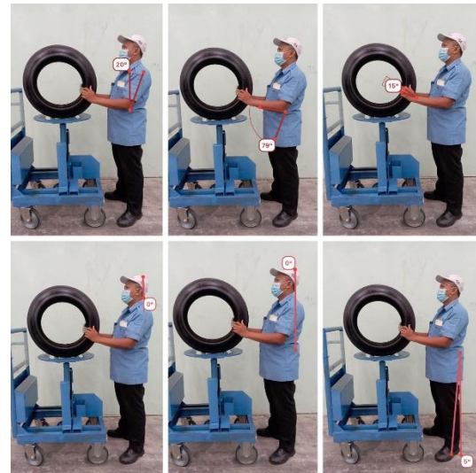
Gambar 7. Inspector Memeriksa Green tire Menggunakan Alat Inspeksi
