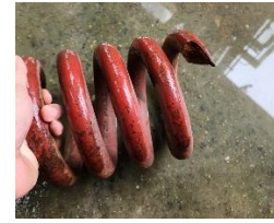
Gambar 3. Steel Spring Patah Sumber: (Dokumen Perusahaan,2024)
